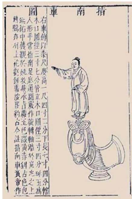
明朝王圻撰寫的《三才圖會》，繪有一幅指南車圖，是根據先前所見的一款實物描畫的，旁註指出：「琢玉為人形，手常指南，足底通圓竅，作旋轉軸。」
