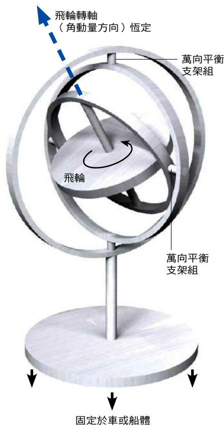
近代的機械式陀螺儀示意圖。
