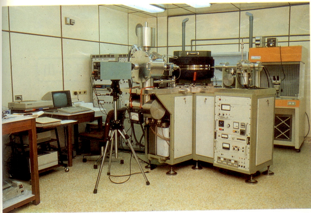
↑圖 1：VG354質譜儀能以高精度和高敏度測定固態元素之同位素含量比值，可用於放射性定年及同位素追蹤工作，是地球化學研究的利器。
